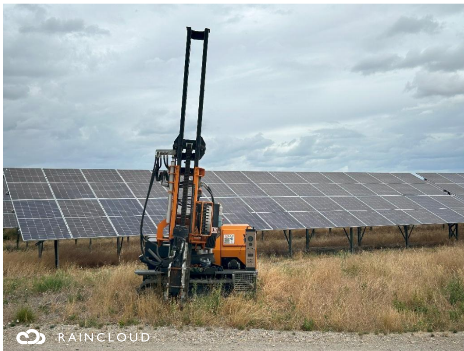
Plate 12-23 Mini pile driver examples
